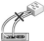
Abbildung 2-3. Inkorrekte Verkabelung für CMC-Netzwerkverbindung - 1 CMC
